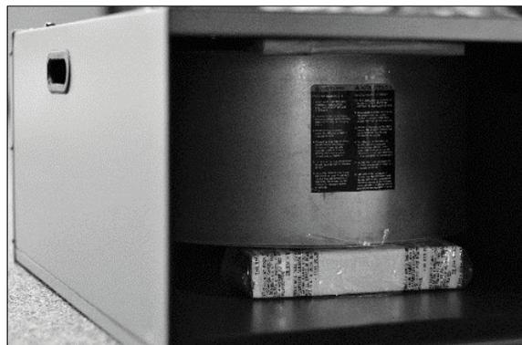
**Vor der Inbetriebnahme müssen lediglich der Außen- und Innenfilter ausgebaut und die Styroporfüllungen entfernt werden. Diese Füllungen dienen als Schutz vor Motorschäden beim Transport.**
